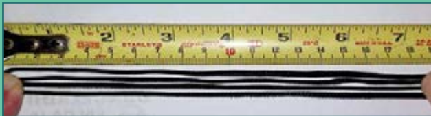
Figura 15. Medición en pulgadas de la longitud del mecate doblado en cuatro.
