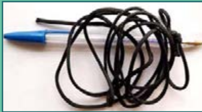
Figura 11. Mecate utilizado para medir madera en el sistema PMT.
